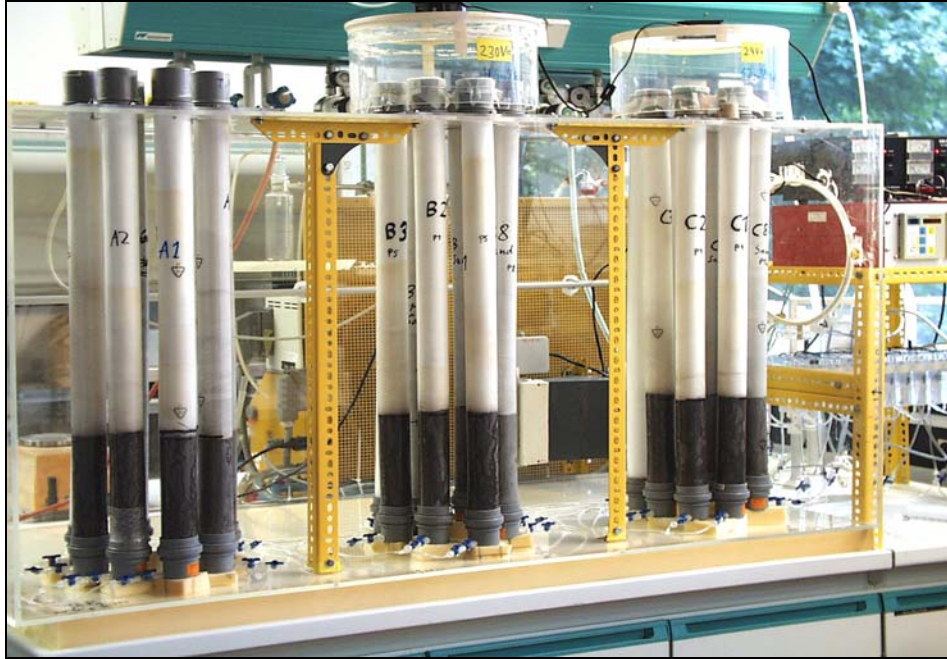
Abbildung 68: Zur Untersuchung der Krustenbildung im Labor werden Säulenversuche in einer beheizbaren Klimakammer durchgeführt. Die mittlere und rechte Säulengruppe auf der Abbildung sind mit Lüftern ausgestattet, die einen Luftstrom erzeugen (s. Abschnitt 5.2).
