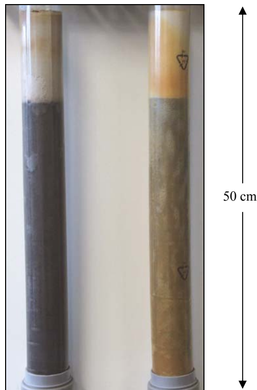
Abbildung 76: Äußerliche Oxidationserscheinungen an der mit sedimentärem Pyrit (links) und der mit hydrothermale Pyrit befüllten Säule (rechts) nach 135 Tagen Versuchsdauer.
