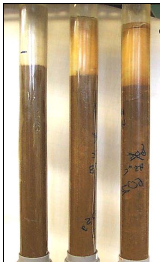
Abbildung 136: Unterschiedlich starke Verfärbungserscheinungen an den drei mit unverwitterten Aufbereitungsabgängen der Matchless-Mine befüllten 50 cm langen Säulen (links 25^\circ , Mitte 35^\circ , rechts 45^\circ \text{C} ).
