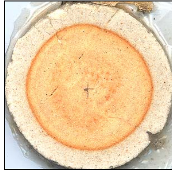
Abbildung 14: Querschnitt durch eine Säule, die im Kern des Quarzsandabschnitts sekundäre Veränderungen erfahren hat und gegen den Rand durch einen scharfen chemischen Gradienten abgegrenzt ist (Durchmesser 5 cm).
