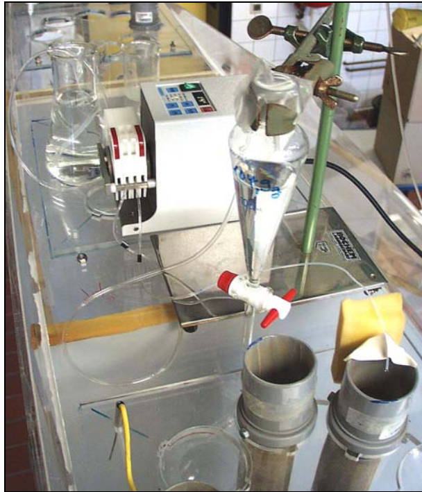
Abbildung 4: Versuchsaufbau des Säulenversuchs zur Untersuchung des Einflusses der Häufigkeit von Niederschlagsereignissen auf den Krustenbildungsprozeß. Eine Schlauchpumpe gibt zweimal dieselbe Wassermenge ab, die entweder subkontinuierlich auf die Oberfläche einer Säule tropft (rechts) oder in einen Vorratsbehälter geleitet wird, der einmal wöchentlich innerhalb weniger Minuten auf die andere Säule (links) entleert wird.
