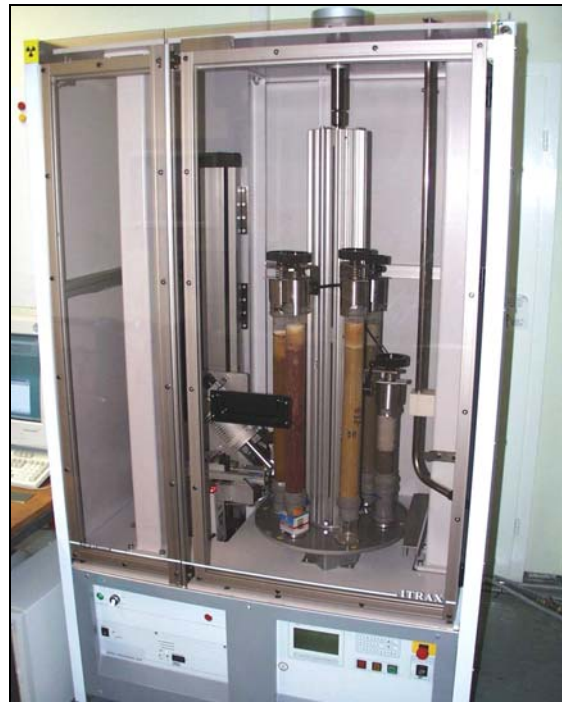
Abbildung 12: Itrax ® Geoscanner. Auf einer Drehtrommel sind mehrere Säulen eingespannt. Links von ihnen befindet sich die vertikal und horizontal bewegliche Röntgenröhre und der unter 45° dazu angeordnete Detektor.
